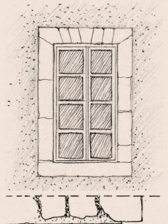
Enduit s'arrêtant au nu de la pierre de taille, la limite pierre/enduit est régulière.
