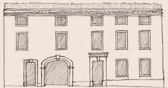
Ici le rez-de-chaussée est marqué par un porche avec voussure en pierre de taille et deux portes avec encadrement en pierre de taille. Les ouvertures des étages supérieurs sont alignées et proportionnées. Le simple changement de couleur des volets suffit à marquer le changement de parcelle.
